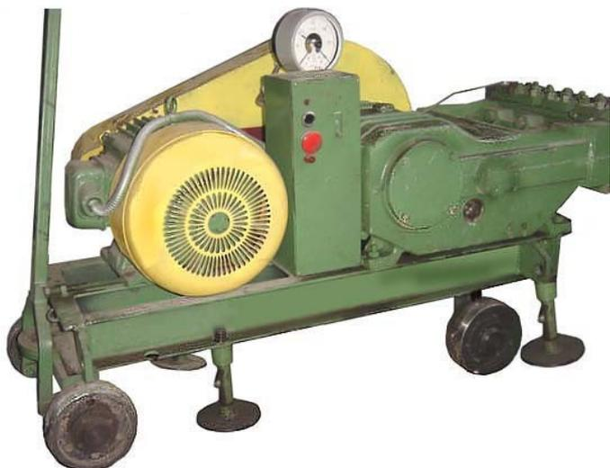
Установка предназначена для опрессовки водяных и паровых трубопроводов и запорной арматуры избыточным давлением воды при проведении монтажных, ремонтных работ и технического обслуживания паровых и водяных магистральных трубопроводов. Для перемещения установка смонтирована на тележке с поворотными передними колесами.
