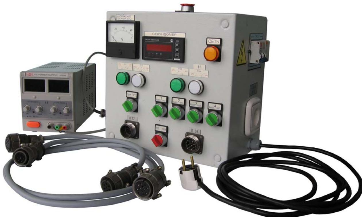
Стенд предназначен для проверки работоспособности и правильного функционирования блоков предварительной световой сигнализации АЛСН типа Л77 и блоков контроля самопроизвольного трогания поезда типа Л168.
