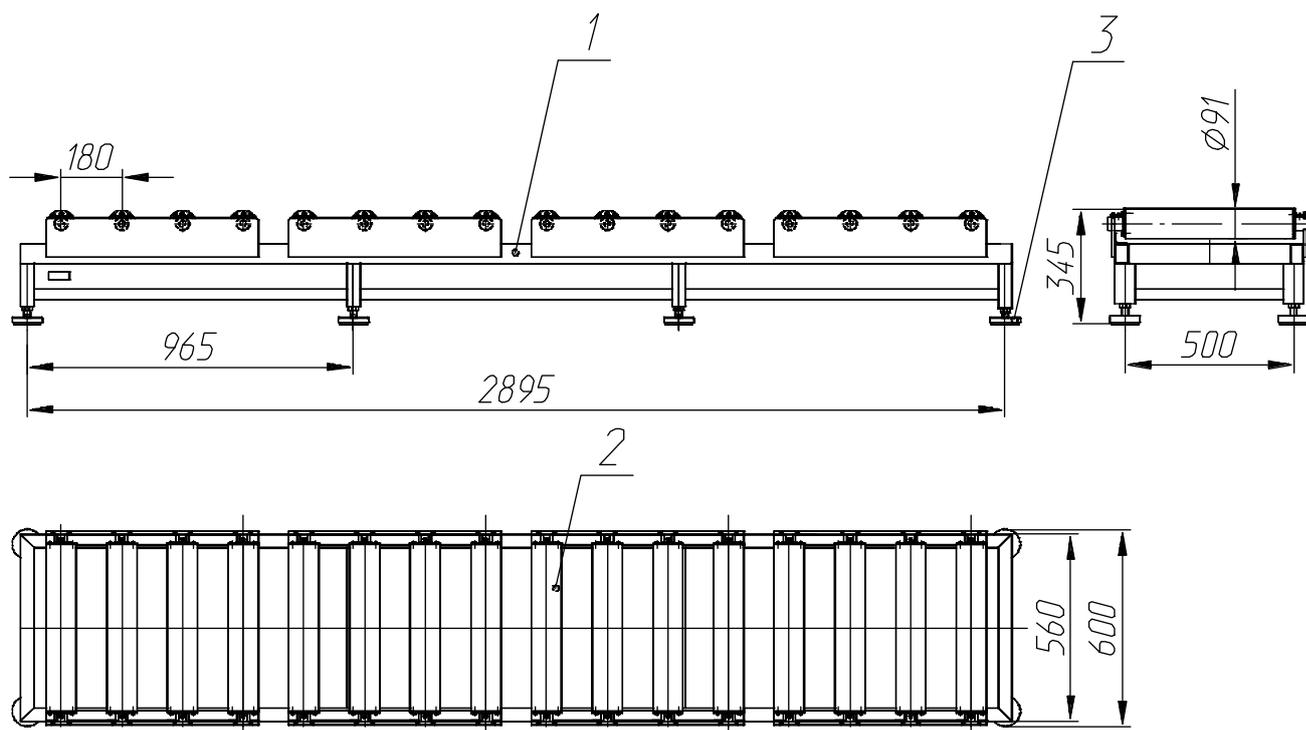
1 - каркас; 2 - ролик; 3 - опора
