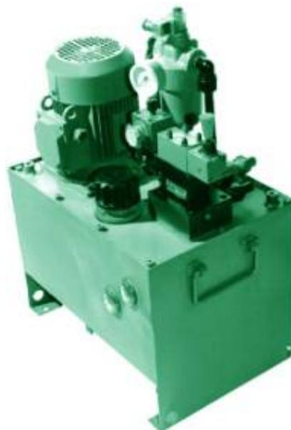
Станция гидропривода для комплекса
