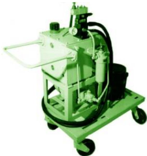
Станции гидропривода для системы при-
